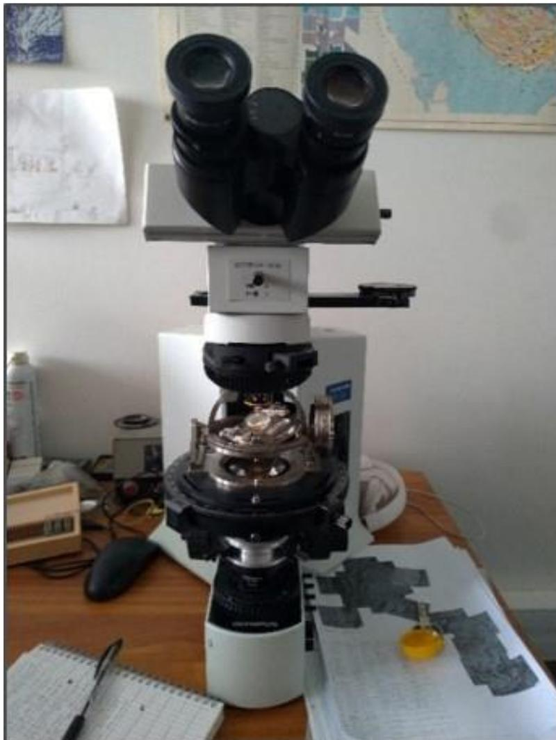
**Figure 10:** Photo de microscope muni d'une platine universelle
