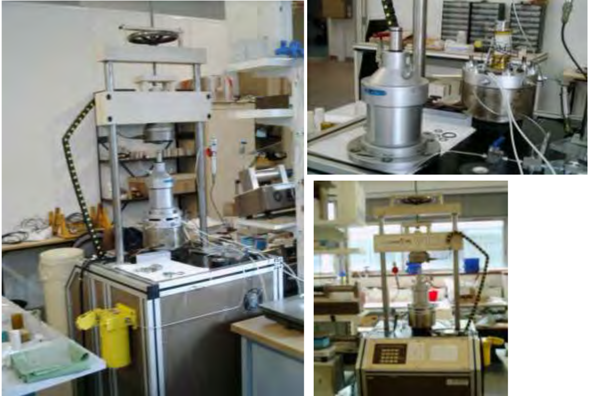
Figure 78: Presse utilisée pour les essais mécaniques.
