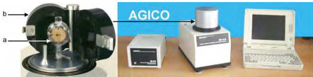
Figure 45: Magnétomètre JR5-A et son porte échantillon (a), dans le boîtier contenant les bobines de mesure (b).
