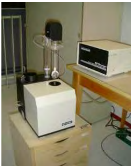
Figure 44: Susceptomètre Kappabridge AGICO KLY-3S et son unité de contrôle.
