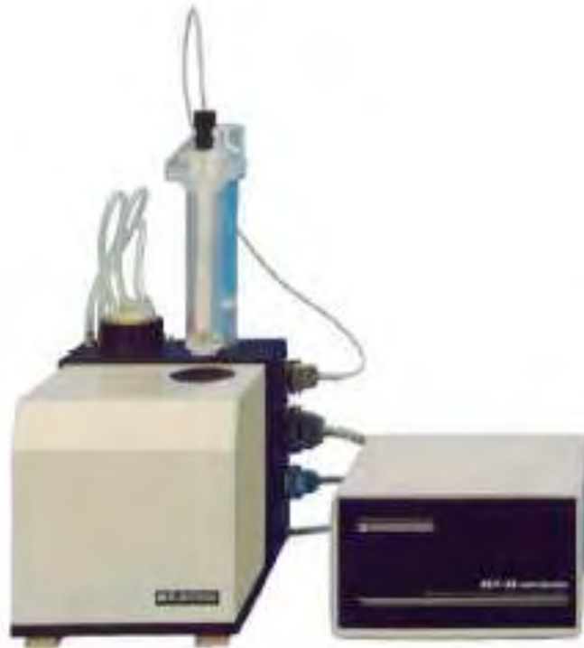
Figure 40: Dispositif CS-3 (four)-CSL (cryogénique) couplé au susceptomètre KLY-3 (IPG-St. Maure).
