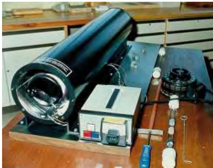
Figure 39: Le four Schonstedt TSD-1, utilisé pour la désaimantation thermique des échantillons dans l'intervalle 20°C - 800°C, avec une chambre de chauffage et une autre, dans l'axe de la première, pour le refroidissement en champ nul.
